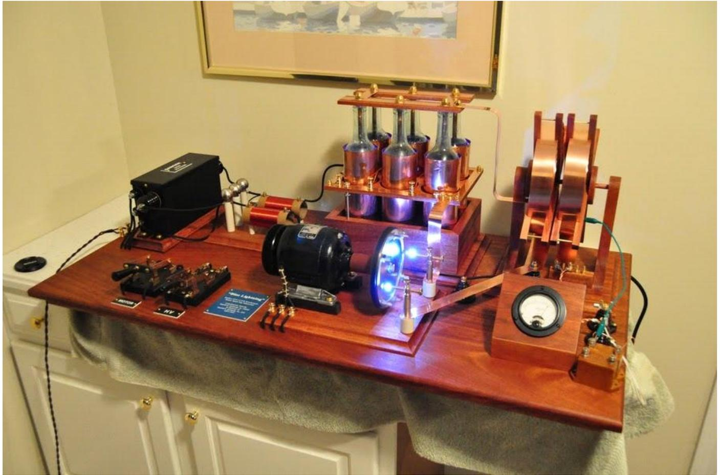
**MODEL OF SPARK GAP TRANSMITTER**
